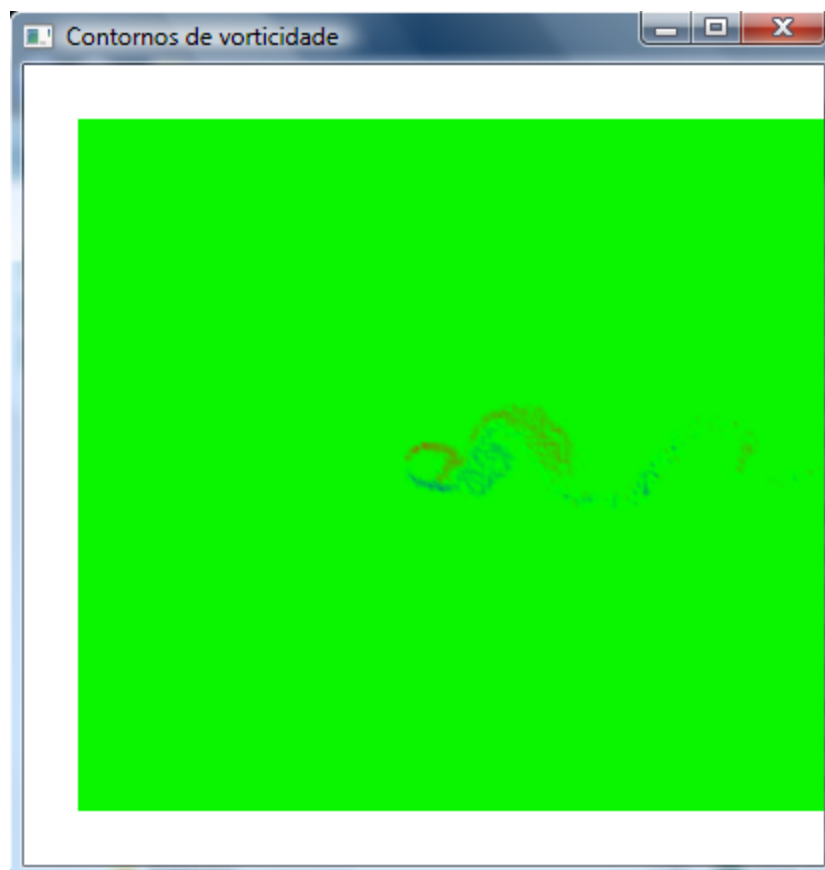
Figura 0.346 Contorno de vorticidade do primeiro vórtice inferior a ser desprendido
